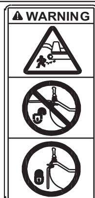
34 AVERTISSEMENT ! Lorsque vous quittez la machine, abaissez le levier de verrouillage des commandes pour verrouiller le système.
